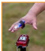
**PINZA CRONOMETRAJE AIR:** Pinza electrónica que no necesita ser insertada en la base. Especial para personas con parálisis o amputaciones de miembros superiores.
